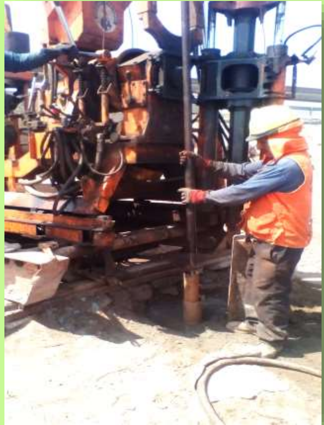
PERFORACIONES DE SPT CON RECUPERACIÓN DE MUESTRA
