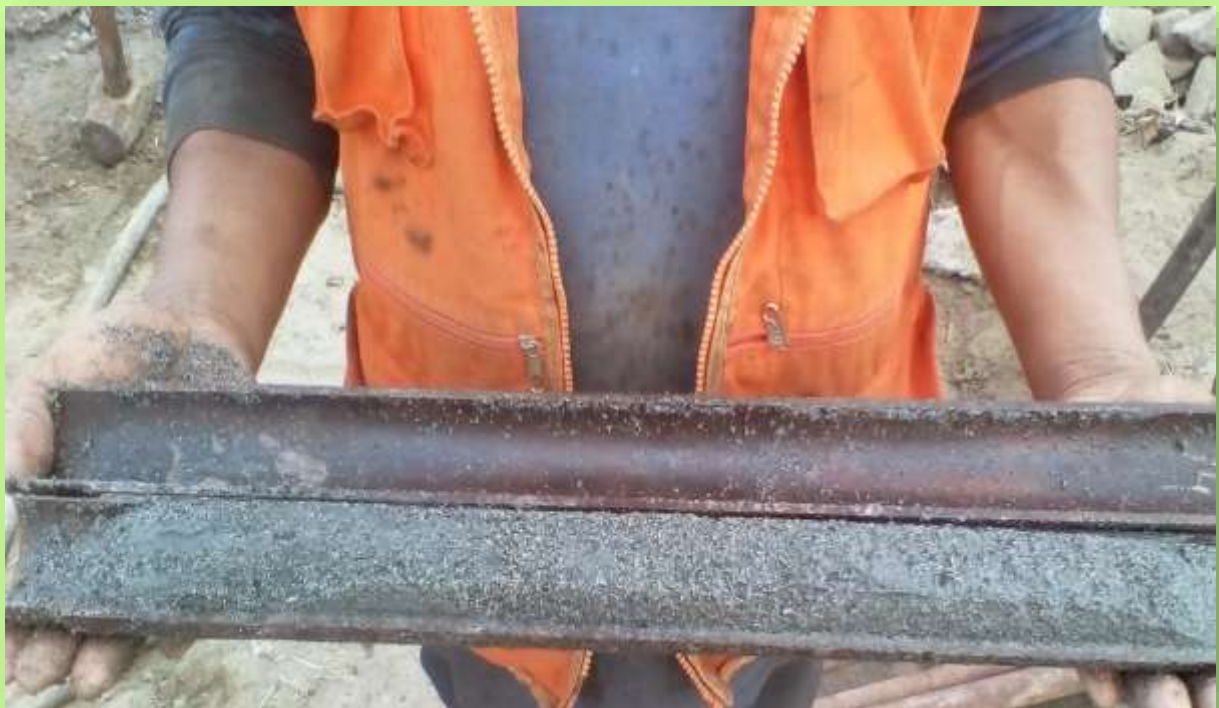
PERFORACIONES DE SPT CON RECUPERACIÓN DE MUESTRA
